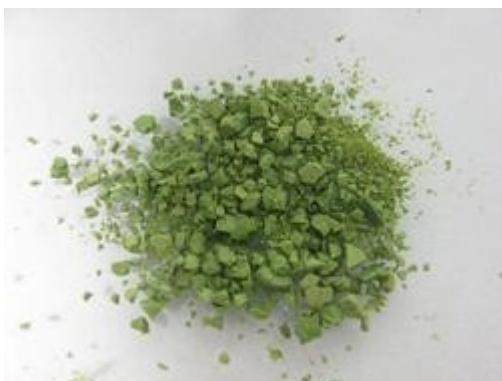
Photokatalytische Farbpigmente: Farbstoffmoleküle sollen den Oxidationsprozess bei Titandioxid-Nanopartikeln bereits bei weniger energiereichen, langwelligem Licht in Gang bringen. (Quelle: Uni Kassel)
