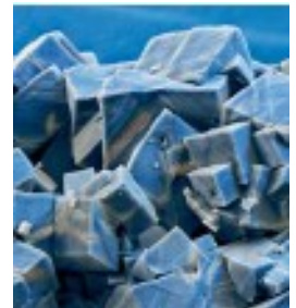
Nanowürfel könnten künftig die Leistungsfähigkeit von Wasserstoff-Speichern erhöhen. S.(Quelle: BASF)
